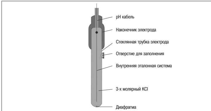
Рис. 8: Конструкция электрода сравнения
