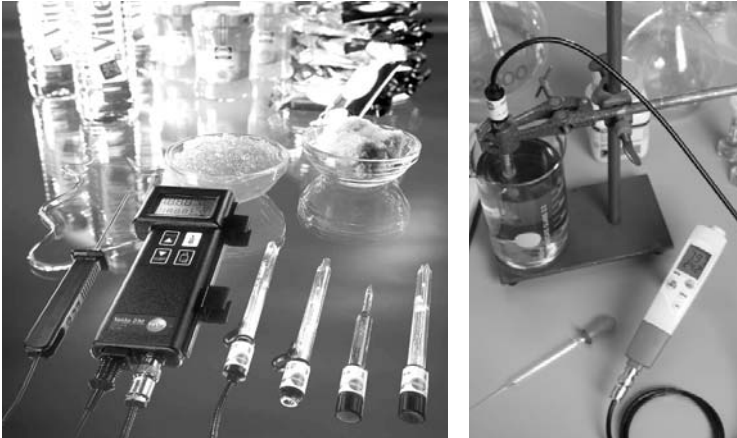
Рис. 3: Пример pH измерительных систем с подсоединяемыми измерительными зондами (testo 230 с pH-зондом и температурным зондом из нержавеющей стали, testo 206-pH3).
