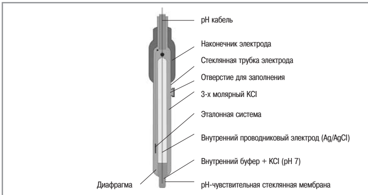
Рис. 9: Конструкция комбинированного электрода
