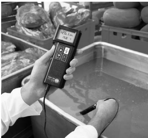
Рис. 31: Измерение электропроводности в рассоле при производстве ветчины
