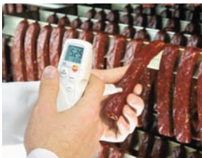
Рис. 9: Измерение значения pH мясных и колбасных изделий
