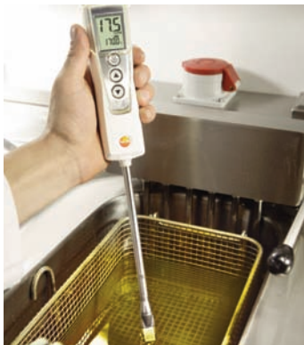
Рис. 12: Измерение значения TPM масла для жарки с помощью testo 270
