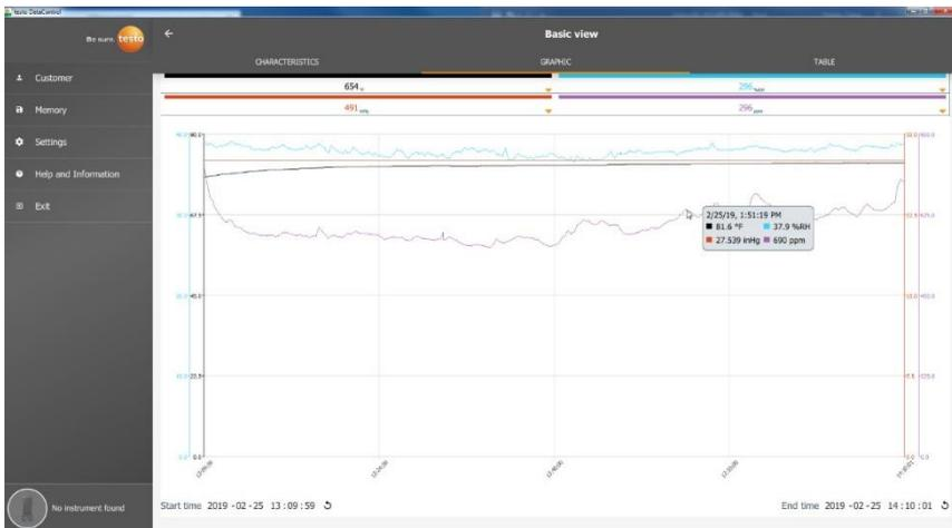
При нажатии на один из четырех каналов открывается окно выбора параметров измерений, записанных во время выполнения измерений. Параметры измерений могут быть легко назначены для выбранного канала, с помощью ID зонда, или быть помечены как **не назначенные (not assigned)**.
