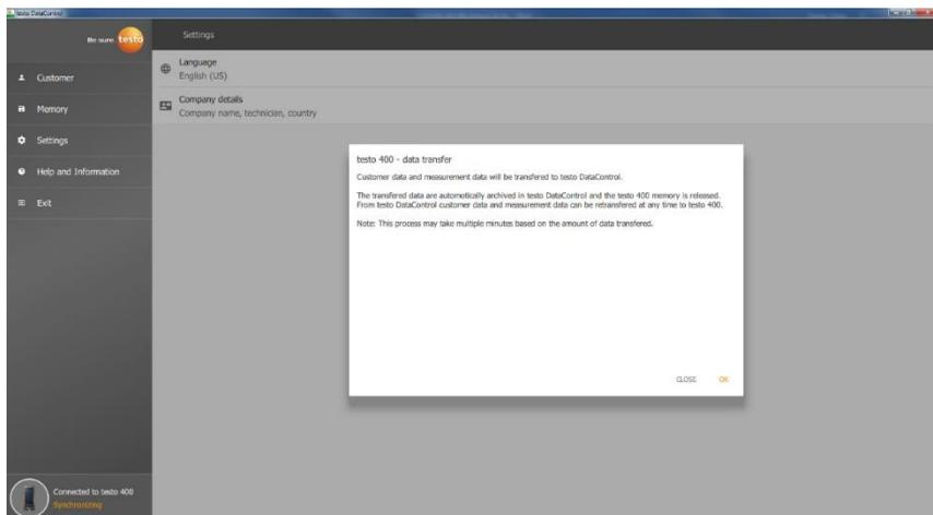
После того как Testo 400 будет подключен к компьютеру через USB кабель, в левом нижнем углу отображается сообщение **Подключен testo 400 - Синхронизация (Connected to testo 400 – Synchronizing)** отображается в левом нижнем углу.
