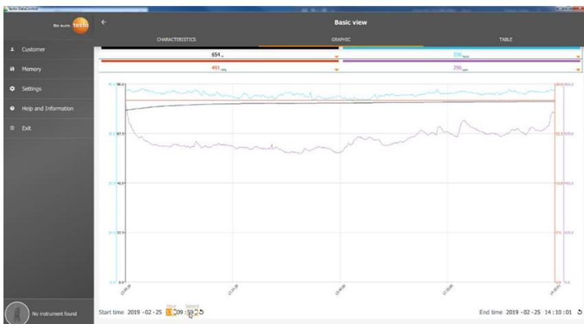
На рисунке выше общее время измерений составляет 60 мин. После изменения времени начала на графике отображаются только последние 10 мин. Регулировка времени позволяет выполнить более детальный анализ измеренных значений.
