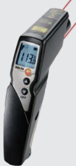
Рассчитанный на универсальное применение инфракрасный термометр testo 830-T4 оснащен 2-х точечным лазерным целеуказателем и оптикой 30:1. Данные поверхностной температуры, в том числе температуры малых объектов, могут быть получены с безопасного расстояния. Диаметр точки замера на расстоянии 1 метр составляет всего 36 мм. Еще большую гибкость при измерениях обеспечивают дополнительные внешние зонды.
