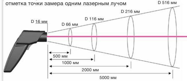
**Инфракрасный термометр с 2-х точечным лазерным целеуказателем и разъемом для внешних зондов**
